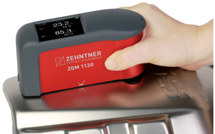
Gloss measurements on metals / Glanzmessung auf Metallen
